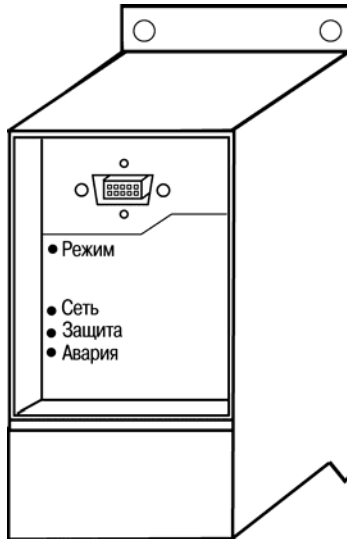
Рисунок 3.2 – Лицевая панель прибора. Отсек подключения ЛПО
