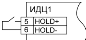
Рисунок 6.1 – Подключение коммутирующих устройств к контактам «HOLD»
