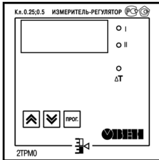
Рисунок 3.4 – Лицевая панель прибора
