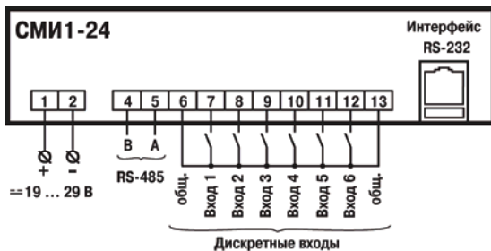
Рис. Б.2. Схема подключения питания, дискретных входов, интерфейсов RS-232 и RS-485 панели СМІ1-24
