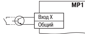
Рис. Б7. Схема подключения транзисторного ключа или коммутирующего устройства ко входу MP1
