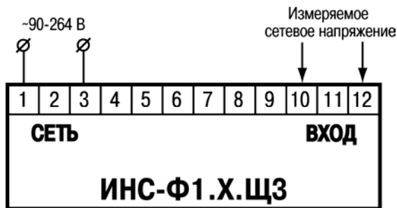
Рисунок Б.1 – Схема подключения прибора ИНС-Ф1.х.ЩЗ
