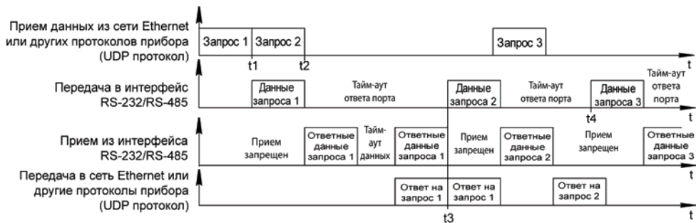
Рисунок 4.7 – Диаграмма работы прибора в режиме «запрос – ответ»
