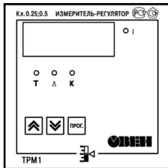
Рисунок 3.4 – Лицевая панель прибора
