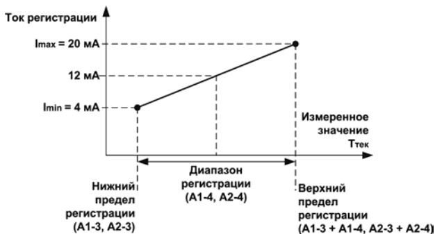
Рисунок 3.13 – Принцип формирования тока регистрации
